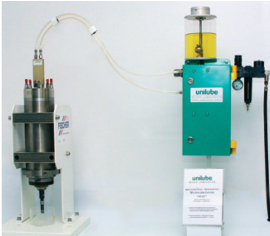
Bild 4. Versuchsaufbau: MinimalSchmierSystem mit Werkzeuginnenschmierung an einer HSC-Spindel für Drehzahlen bis 40\,000\text{ min}^{-1} (Bild: Unilube AG, Kreuzlingen)
