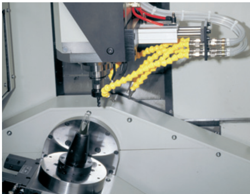
Bild 3. Optimaler Werkzeugwechsel und Schmierfilmauftrag: Düsenhandlingsvorrichtung an einem Bearbeitungszentrum (Bild: Willemin Macodel SA, Bassecourt)
