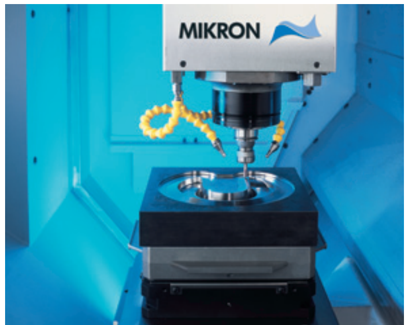
Bild 1. Werksausrüstung: Bearbeitungszentrum mit 2-Düsen MinimalSchmierSystem (Bild: Mikron AG, Nidau)
