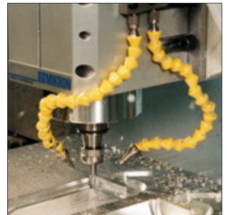
Fraisage haute vitesse de cavités, système de lubrification minimale Unilube à 2 buses
