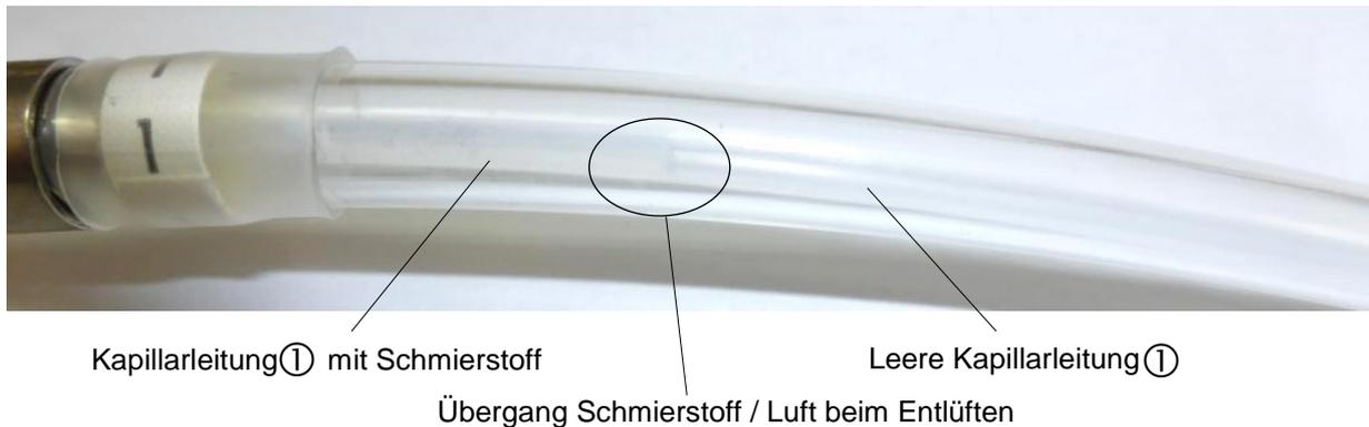
Abb. 18: Kapillarleitung ① füllt sich mit Schmierstoff während des Entlüftens
