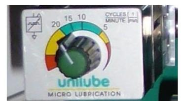
Abb. 14: Pneumatischer PulsGenerator – Werkseinstellung 20 Takte / min
