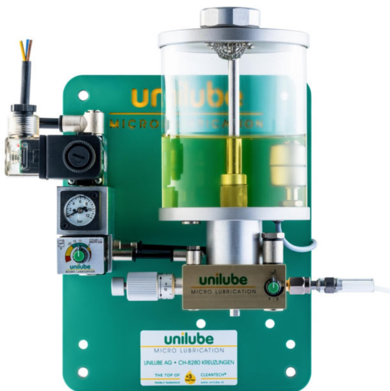
Fig. 1 : Système de lubrification minimale ECOLUBE « \mu » version 1D avec options, comme soupape de commande principale avec connecteur DEL et Contrôle du niveau
