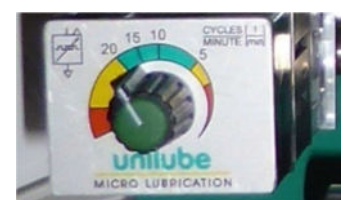
Fig. 14 : Générateur d'impulsions pneumatique - réglage d'usine 20 cycles/min
