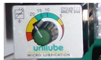
Fig. 14: Generatore di Impulsi Pneumatico - impostazione di fabbrica 20 cicli/min
