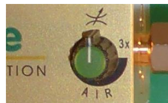
Fig. 16: Regolazione aria - impostazione di fabbrica 1 giro aperto
