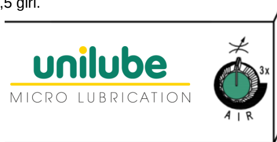
Fig. 12: Manopola di regolazione con indice - portata di aria miscelata
