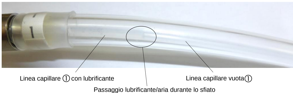
Fig. 18: La linea capillare ① si riempie di lubrificante durante lo sfiato
