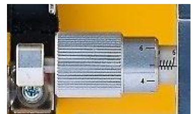
Abb. 14: Mikrometerschraube – Werkseinstellung 0.5 Umdrehungen
