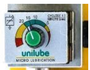
Abb. 15: Pneumatischer PulsGenerator – Werkseinstellung 15 Takte / min
