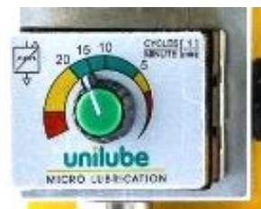
Fig. 15: Générateur d'impulsions pneumatique - réglage d'usine 15 cycles/min
