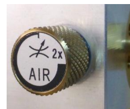
Fig. 17: Regolazione aria - impostazione di fabbrica 1 giro aperto
