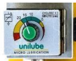
Fig. 15: Generatore di Impulsi Pneumatico - impostazione di fabbrica 15 cicli/min
