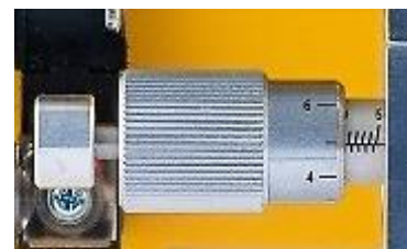
Fig. 14: Vite micrometrica- impostazione di fabbrica 0,5 giri
